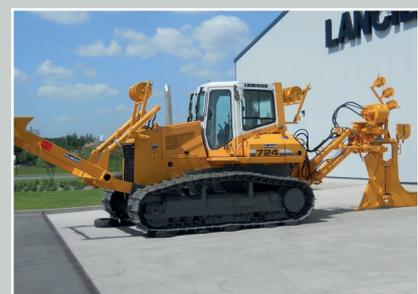
**Vibrations-Kabelpflug KV 15**
